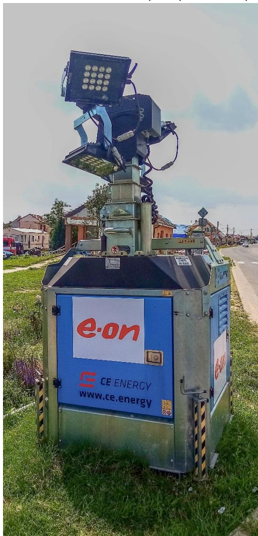
Výkonná výsuvná dieselová osvětlovací souprava.
