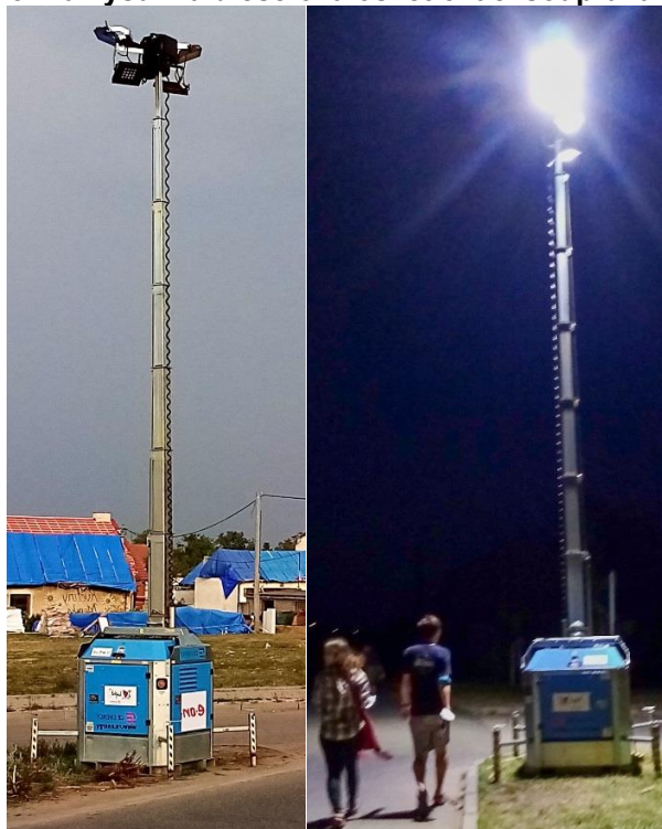
Výkonná výsuvná dieselová osvětlovací souprava.
